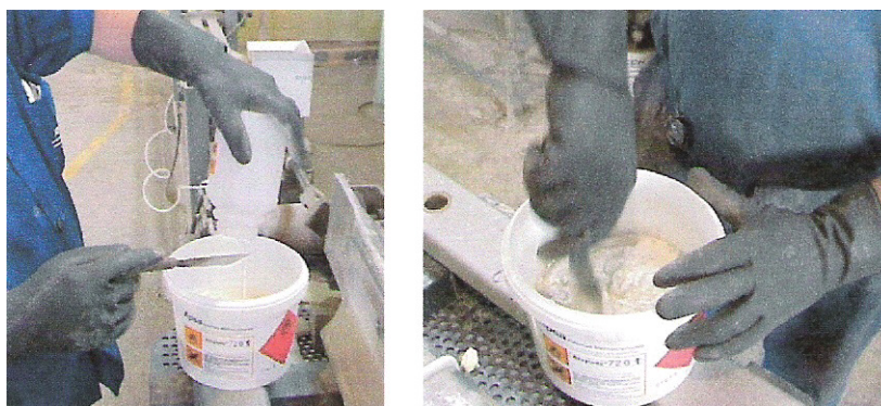
Figura 9 – Procedimento de mistura dos componentes da cola.
